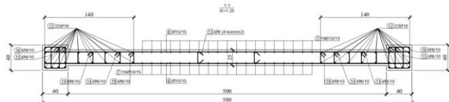
Slika 6. Usvojena armatura zida u kritičnoj zoni (DCM)
