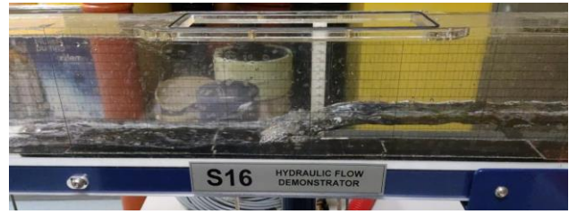
Слика 4: Хидраулички скок добијен у лабораторији
