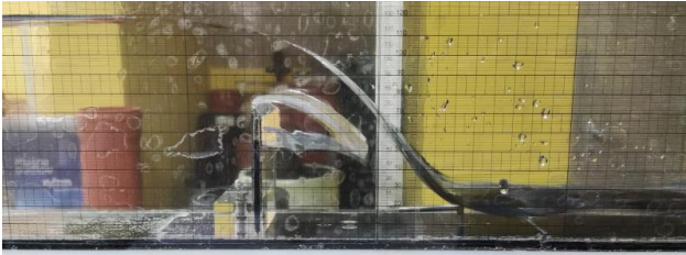
Слика 1: Приказ канала из лабораторије за случај оштровичног прелива - Q_1
