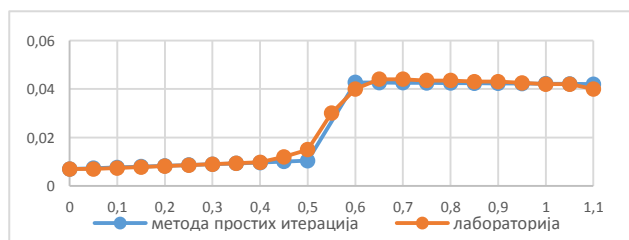
График 5: Поређење хидрауличког скока добијеног преко методе простих итерација и лабораторије ( L \approx 0.1m )
