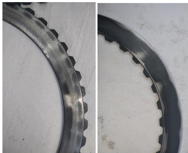
Slika 1. Primer ekstremno potrošenih lamela spojnice
