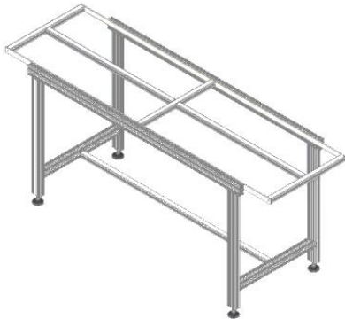
Слика 7. Приказ конструкције са укрућењем
