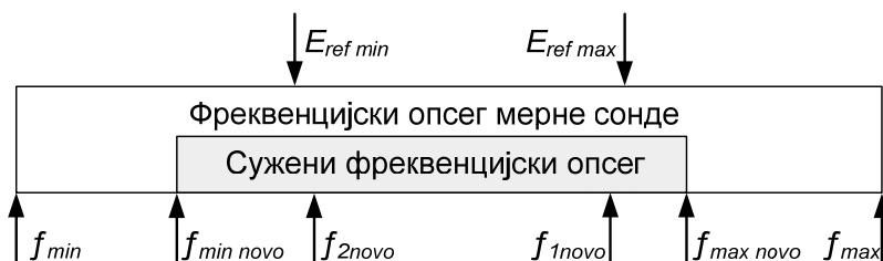
Слика 2. Избор прикладнијег минималог и максималног прописаног референтног граничног нивоа, за конкретну мерну локацију.
