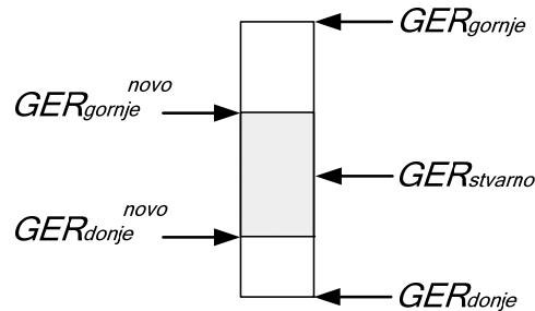
Слика 3. Смањење разлике између граница изложености електричном пољу високих фреквенција.
